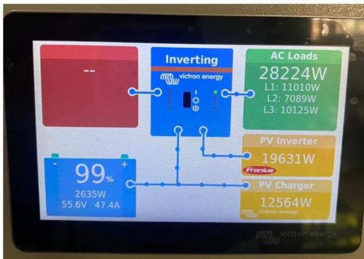
Hydro et PV couplé, alimentent l'hopital et chargent les batteries
